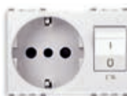
20276.B 16 A P30 250 V~, 1P+N C 16 - 3 modula. Dubina: 39,8 mm
