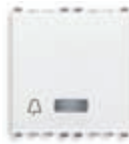
20183.B Set/Reset sklopka za hitni poziv, 2 NO 5 A 250 V~ relej 12 V~/12-24 Vdc - 2 modula. Dubina: 38,5 mm
