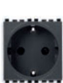
20208 SICURY 2P+E 16 A, njemački - 2 modula. Dubina: 29,4 mm
