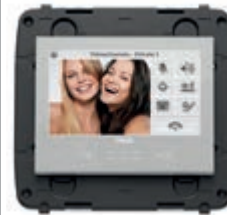
21554.BN Video zaslon osjetljiv na dodir 4,3" Full Flat za unutarnje videoportafonsko mjesto Due Fili za nadzor i komandu, ulaz za senzor temperature, upotpunjen nosačem za ugradnju u kutije s 8 modula. Dubina: 46,7 mm
