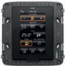
21848.1 Dodirni zaslon u boji 4,3", Full Flat, za kontrolu i upravljanje, 1 ulaz za senzor temperature, opremljen nosačem za instalaciju u kutije 8 modula. Dubina: 50,4 mm
