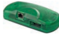
01712 Sučelje za ethernetsku mrežu (LAN) i domotički sustav By-me (putem Web poslužitelja 01945, 01946), nadzor/daljinsko i lokalno upravljanje putem protokola IP
