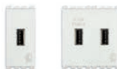
19292.B 5 V 1,5 A napajač s izlazom, 1 USB, 100-230 V~ 50/60 Hz. Dubina: 36,5 mm 19295.B 5 V 2,1 A napajač s izlazom, 2 izlaza USB koji sveukupno daju 2,1 A, 120-230 V~ 50/60 Hz - 2 modula. Dubina: 37 mm
