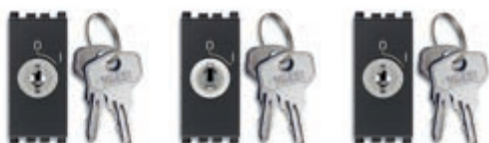
19082 16 AX obična sklopka, ključ se može izvaditi u 'O' (OFF) položaju. Dubina: 33 mm 19083 16 AX obična sklopka, ključ se može premjestiti u obje pozicije. Dubina: 33 mm 19086 NO 16 A tipkalo, ključ se može izvaditi u 'O' položaju. Dubina: 33 mm
