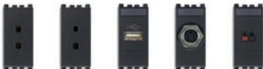
19330 2P 6 A 24 V (SELV), za utikače 01620. Dubina: 24,5 mm 19331 2P 6 A 24 V (SELV), za utikače 01616/ 01617. Dubina: 24,5 mm 19345 USB, vijčani priključci. Dubina: 24,2 mm 19347 S-Video, 4 kontakata. Dubina: 15,5 mm 19583 Opružna spojnica za uređaj za ozvučenje. Dubina: 18,9 mm
