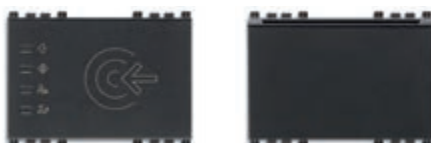
19457 Transponder čitač za instalaciju izvan sobe, standard KNX, 2 relejna izlaza NO 4 A 24 V~, 2 ulaza, 12-24 V~ 50/60 Hz i 12-24 Vdc (SELV) - 3 modula. Dostavlja se bez transponder kartica. Dubina: 37 mm 19453 Transponder čitač s okomitim pretincem za instalaciju unutar sobe, standard KNX, 2 relejna izlaza - NO 4 A 24 V~, 2 ulaza, 12-24 V~ 50/60 Hz i 12-24 Vdc (SELV) - 3 modula. Dubina: 37 mm
