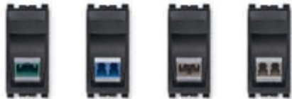
▲19350.SC Jednomodalni 9/125 µm, s adapterom tipa SC/APC simplex. Dubina: 19,4 mm ▲19350.LC Jednomodalni 9/125 µm, s adapterom tipa LC duplex. Dubina: 19,3 mm ▲19351.SC Višemodalni 50/125 µm, s adapterom tipa SC simplex. Dubina: 19,4 mm ▲19351.LC Višemodalni 50/125 µm, s adapterom tipa LC duplex. Dubina: 18,2 mm
