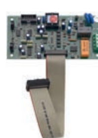
01708 Komunikator PSTN za središnju upravljačku jedinicu
