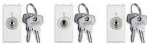
19082.B 16 AX obična sklopka, ključ se može izvaditi u 'O' (OFF) položaju. Dubina: 33 mm 19083.B 16 AX obična sklopka, ključ se može premjestiti u obje pozicije. Dubina: 33 mm 19086.B NO 16 A tipkalo, ključ se može izvaditi u 'O' položaju. Dubina: 33 mm
