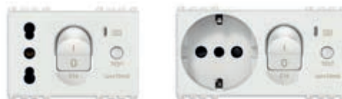
19283.B Bpresa 16 A P17/11 250 V~, 1P+N C 16 - 3 modula. Dubina: 39,6 mm 19286.B 16 A P30 250 V~, 1P+N C 16 - 4 modula. Dubina: 39,6 mm
