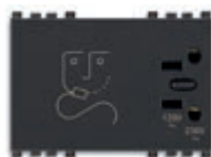
19290 230 V~ 50/60 Hz, s izolacijskim transformatorom 20 VA, 230 V~ i 120 V~ izlaznim naponom - 3 modula. Dubina: 41,5 mm
