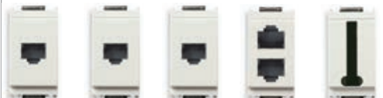
16335.B RJ11, 6-položaja/4-kontakta (6/4). Dubina: 33,5 mm 16336.B RJ12, 6-položaja/6-kontakta (6/6). Dubina: 33,5 mm 16337.B RJ45, 8-položaja/8-kontakta (8/8). Dubina: 33,5 mm 16338.B Dvostruka RJ11, 6-položaja/4-kontakta (6/4). Dubina: 31 mm 16347.B 8-kontakata francuski. Dubina: 21,5 mm
