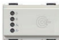
16927.B Transponder čitač za instalaci- ju izvan sobe, standard KNX, 2 relejna izlaza NO 4 A 24 V~, 2 ulaza, 12-24 V~ 50/60 Hz i 12-24 Vdc (SELV) - 3 modula. Dostavlja se bez transponder kartica. Dubina: 36,5 mm
