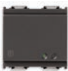
16955 Interface za tradicionalne kontakte 230 V~/12-24 Vac/dc - 2 modula. Dubina: 36,5 mm
