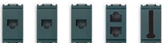
16335 RJ11, 6-položaja/4-kontakta (6/4). Dubina: 33,5 mm 16336 RJ12, 6-položaja/6-kontakta (6/6). Dubina: 33,5 mm 16337 RJ45, 8-položaja/8-kontakta (8/8). Dubina: 33,5 mm 16338 Dvostruka RJ11, 6-položaja/4-kontakta (6/4). Dubina: 31 mm 16347 8-kontakata francuski. Dubina: 21,5 mm
