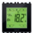
02952 Elektronički termostat osjetljiv na dodir za uprav- ljanje temperaturom u pro- storijama sa 2 nezavisne zone, standard KNX, 1 relejni izlaz NO 4 A 24 V~, 1 ulaz za senzor tempe- rature, 1 digitalni ulaz s mogućnošću programiranja - 2 modula. Instalirati s namjenskim nosačem 16723. Dubina: 38,5 mm
