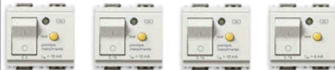
16511.06.B C 6, I Δn 10 mA, prekidna moć 1500 A - 2 modula. Dubina: 38 mm 16511.10.B C 10, I Δn 10 mA, prekidna moć 3000 A - 2 modula. Dubina: 38 mm 16511.16.B C 16, I Δn 10 mA, prekidna moć 3000 A - 2 modula. Dubina: 38 mm 16511.16.6.B C 16, I Δn 10 mA, prekidna moć 3000 A - 2 modula. Dubina: 38 mm
