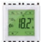
02952.B Elektronički termostat osjetljiv na dodir za uprav- ljanje temperaturom u pro- storijama sa 2 nezavisne zone, standard KNX, 1 relejni izlaz NO 4 A 24 V~, 1 ulaz za senzor tempe- rature, 1 digitalni ulaz s mogućnošću programiranja - 2 modula. Instalirati s namjenskim nosačem 16723.B. Dubina: 38,5 mm
