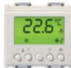
16915.B Termostat za kontrolu okolne temperature u 2 zone uz nezavisno (grijanje i klimatizaciju), standard KNX, relejni izlaz NO 4 A 24 V~ + 1 ulaz senzora temperature + 1 programibilni ulaz - 2 modula. Dubina: 36,5 mm
