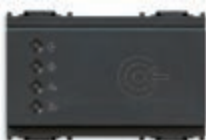
16927 Transponder čitač za instalaci- ju izvan sobe, standard KNX, 2 relejna izlaza NO 4 A 24 V~, 2 ulaza, 12-24 V~ 50/60 Hz i 12-24 Vdc (SELV) - 3 modula. Dostavlja se bez transponder kartica. Dubina: 36,5 mm
