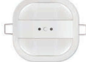
01529.1 Detektor sa senzorom prisutnosti na infracrvene zrake s krugom djelovanja od 360°, za paljenje svjetala ON/OFF u funkciji svjetline i/ili pomicanja, polje osvjetljenosti s mogućnošću regulacije u rasponu od 1-1000 luxa, standard KNX, stropna ugradnja. Dimenzije: 91x91x45 mm
