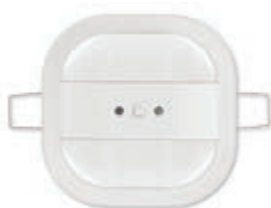
01527 Detektor sa senzorom prisutnosti na infracrvene zrake s krugom djelovanja od 360°, za paljenje svjetala ON/OFF i stalnu regulaciju osvjetljenja, grijanja, klimatizacije, ventilacije u funkciji svjetline i/ili pomicanja, polje osvjetljenosti s mogućnošću regulacije u rasponu od 1-1000 luxa, standard KNX, stropna ugradnja. Dimenzije: 80x80x45 mm
